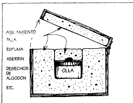
FIGURA 3.23 Olla para cocinar - aislada para cocinar alimentos lentamente (legumbres y granos)
